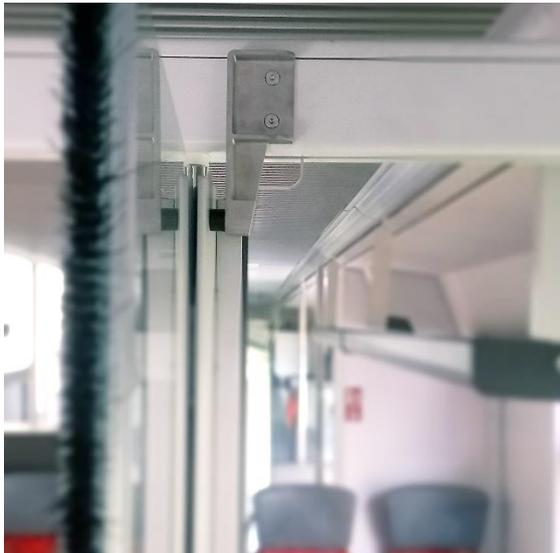
*Mithilfe von Replique konnte der Türstopper innerhalb von nur 1,5 Monaten für die additive Serienproduktion qualifiziert und gefertigt werden.
